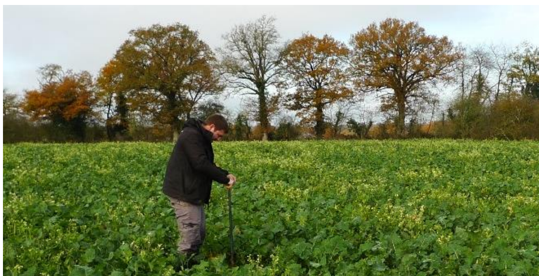
Prélèvement à l'aide d'une tarière pédologique – Calidris
